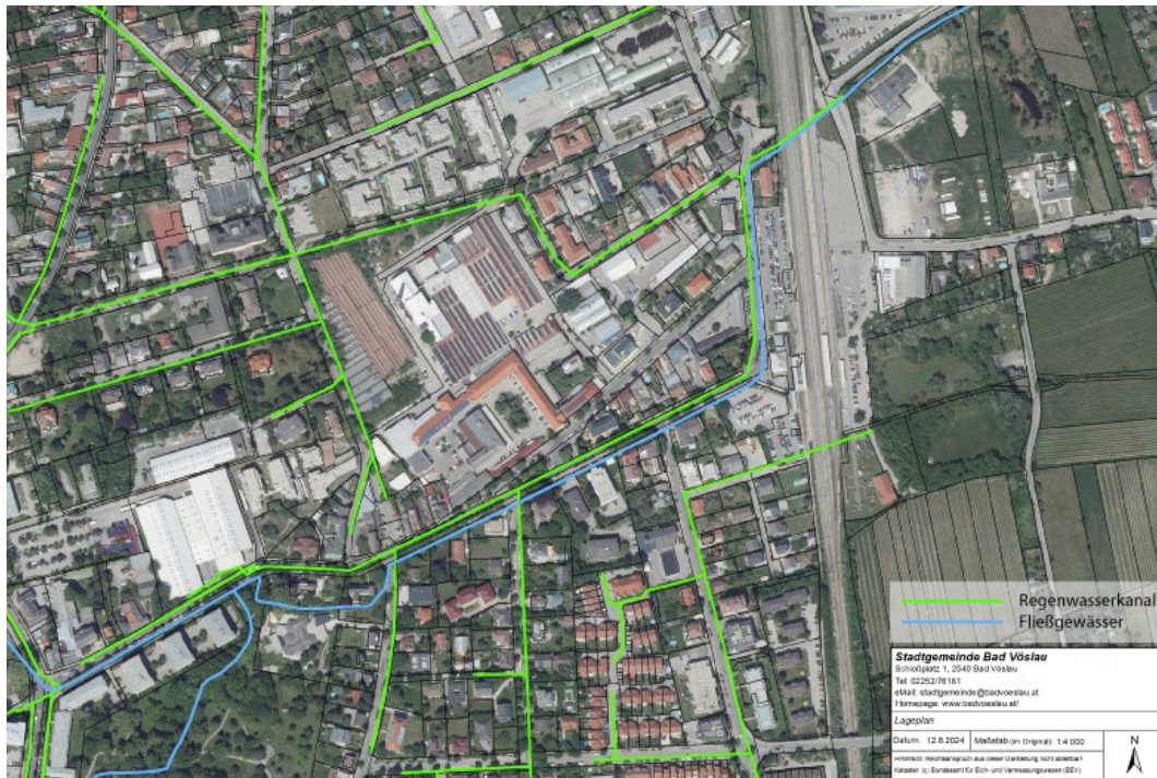
Abbildung 5: Gewässerverlauf und Regenwasserableitung
